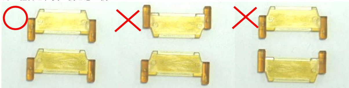
(良い例) 斜めにカッティングされている方が上
