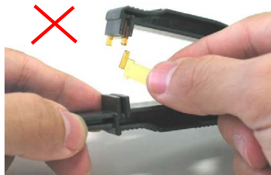
(悪い例) 斜めにカッティングされている方が下
